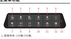
2、麦克风:開/關;; 3、縮時錄像:8H/12H/24H/關閉; 4、屏幕亮度:常規/高亮; 5、自動熄屏:1分鐘/3分鐘/常亮; 6、語音選擇:多國語言; 7、時間設置:設置時間; 8、開機顯示模式:前/後/前後同屏; 9、全屏模式/大廣角模式; 10、格式化:格式化/否; 11、恢復出廠設置:是/否;
